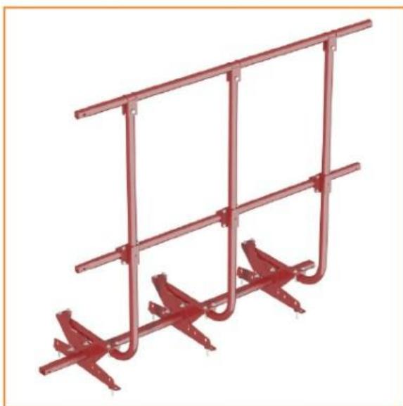
Оптимально устанавливать снегозадержатель отдельно, выше кровельного ограждения. Если это невозможно по тем или иным причинам, кровельное ограждение можно дополнительно укомплектовать трубой снегозадержателя. В данном случае при монтаже кровельного ограждения необходимо установить в нижнее отверстие универсального кронштейна дополнительную трубу овальную 25x45 мм, длиной 3 м, которая выполняет функцию снегозадержателя.
